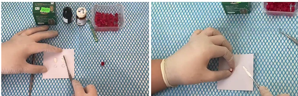
Figura 3. Proceso para la fabricación de probetas de GC Gold Label Fuji 9.
