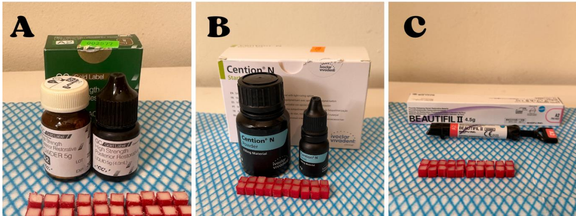
Figura 2. Tres materiales utilizados para la fabricación de probetas. A. GC Gold Label Fuji 9, B. Cention N, C. Beautifil II.
