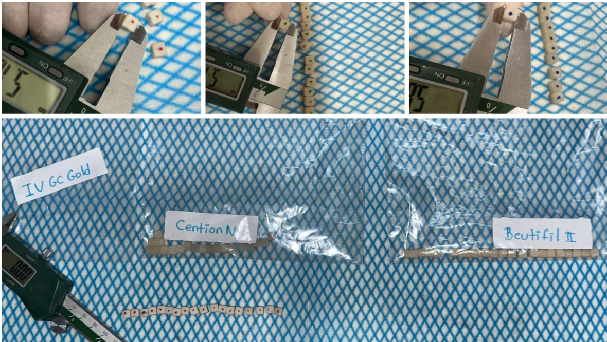
Figura 7. Comprobación de las medidas de cada probeta previo al ensayo de compresión. Fuente de elaboración propia.
