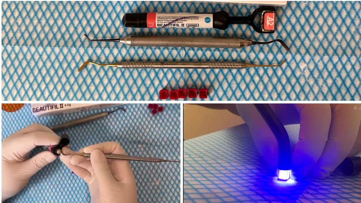
Figura 5. Proceso para la fabricación y fotopolimerización de probetas de Beautifil II. Fuente de elaboración propia.
