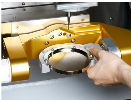
Fig. 30. Disco de Titanio grado 5 en Fresadora ARUM5 X500
