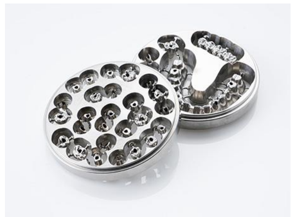
Fig. 29. Disco de Titanio grado 5 en Fresadora ARUM5 X500
