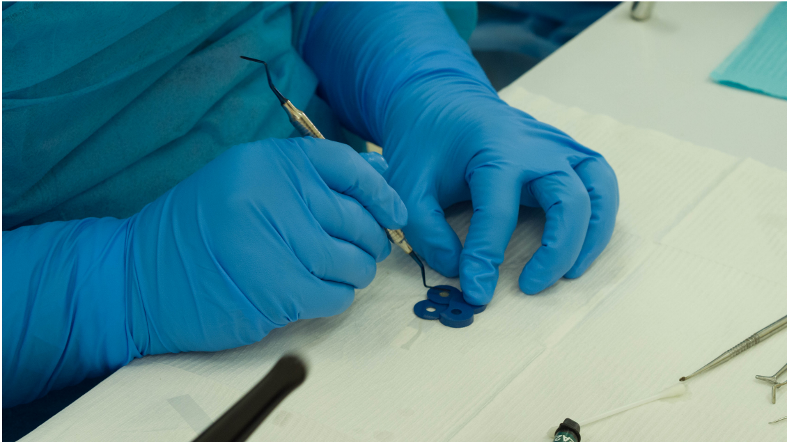
Fotografía 4: Confección de discos de resina bulk fill en molde milimetrado. Fotografía tomada por colaborador Carlos Zepeda.
