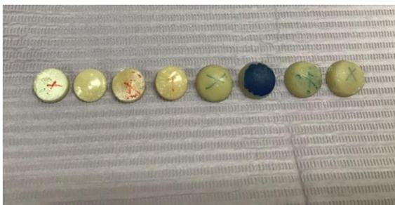
Figura 2. Muestras de Ionómero de vidrio Fuji 9 y resina composita Te-econom Plus con dimensiones de 6mm de alto por 20mm de diametro.
