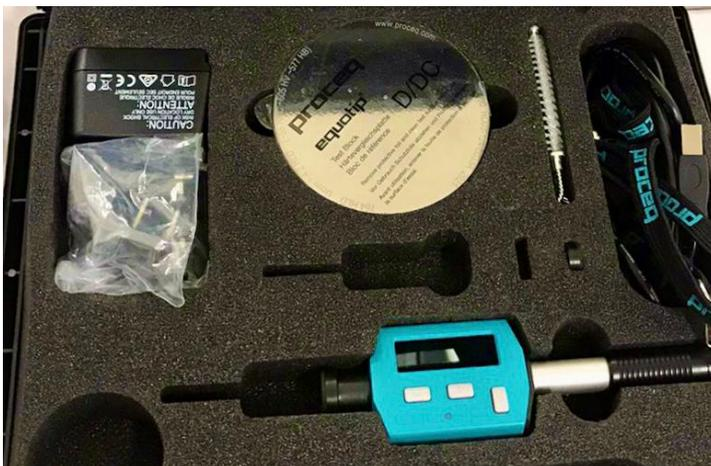
Figura 1. Microdurómetro Equotip. Piccolo Bambino 2.
