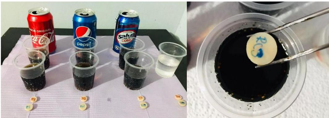
Figura 4. Muestras de ionómero de vidrio y resina compoita sumergidas en bebidas carbonatadas durante 15 minutos por 15 días a temperatura ambiente.
