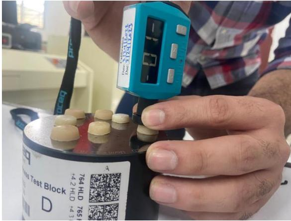
Figura 5. Toma de micro dureza final de muestras de resina composita y ionómero de vidrio en laboratorio de Ensayos de Materiales de la Universidad Don Bosco.
